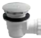
7981 Zuhanytálca szifon Ø 60 mm bekötése: 40 mm, magasság 65 mm, kupak króm
