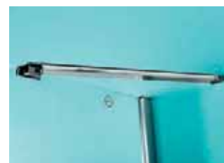
A stabilitás érdekében sarokmerevítő, mely mindkét rögzítési ponton a kívánt szögben állítható.
