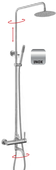
MI140 MINIMAL Zuhanyoszlop, kádtöltő csapteleppel, Ø fejuhany: 200 mm, állítható magasság: 1000-1500 mm, Alapanyag: polírozott inox 132.990,-
