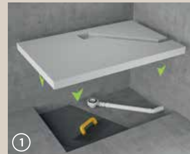
I. Burkolható zuhanytálca beépítése polisztirol alapra
